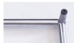
Nimm 6 Stück 350er Rohre für die Höhe und steckst diese auf die Connies und ziehst diese mit dem langen Metall-Inbus satt an.
